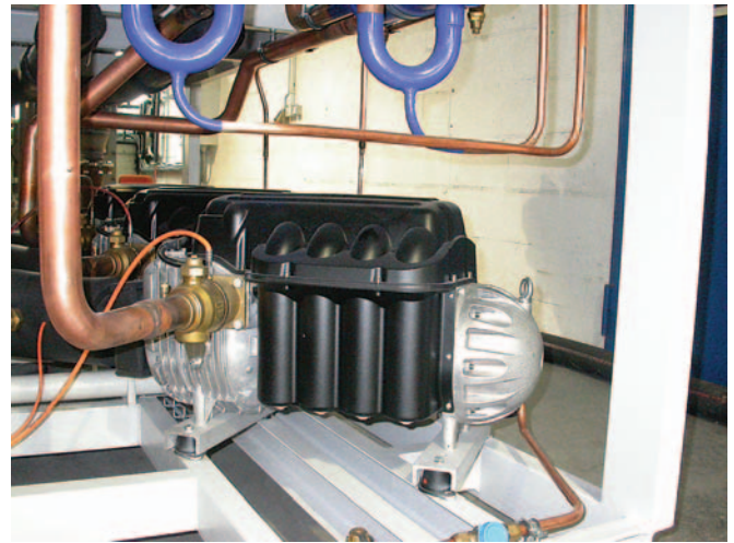
Detailansicht des kanadischen Turboverdichters mit Magnetlagern
